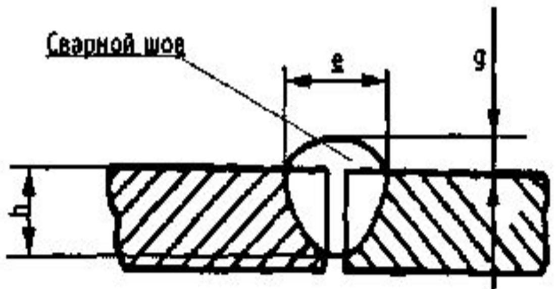
шириной шва ( $e$ ), высотой усиления ( $g$ ), глубиной провара ( $h$ ).
