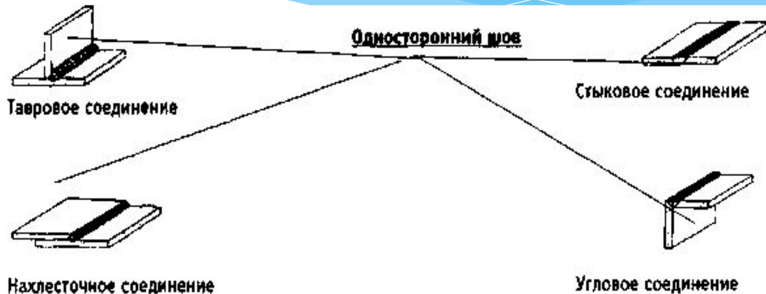
**Односторонний шов** — сварной шов, выполняемый с одной стороны.
