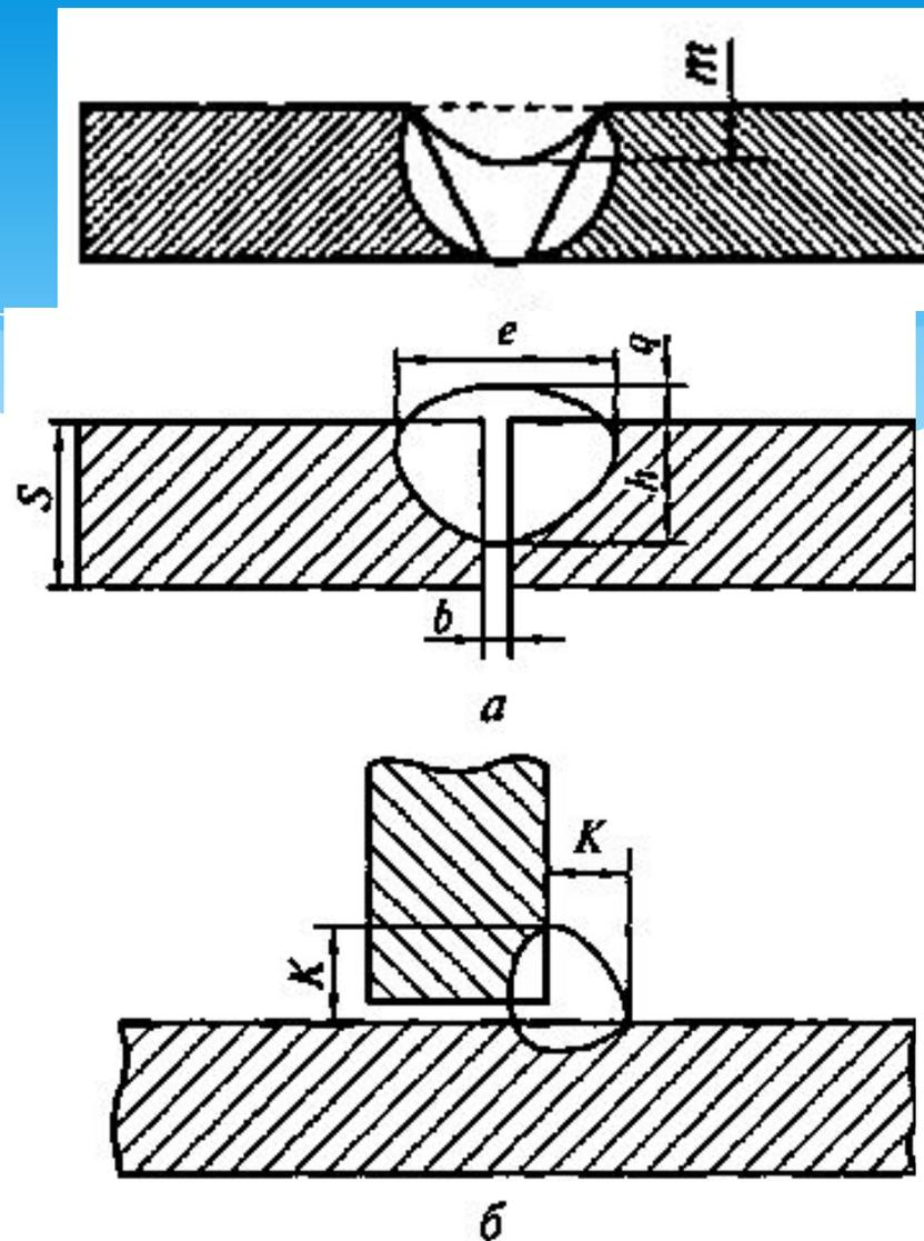
Рис. 1.11. Основные геометрические параметры сварных швов (по ГОСТ 2601—84):
