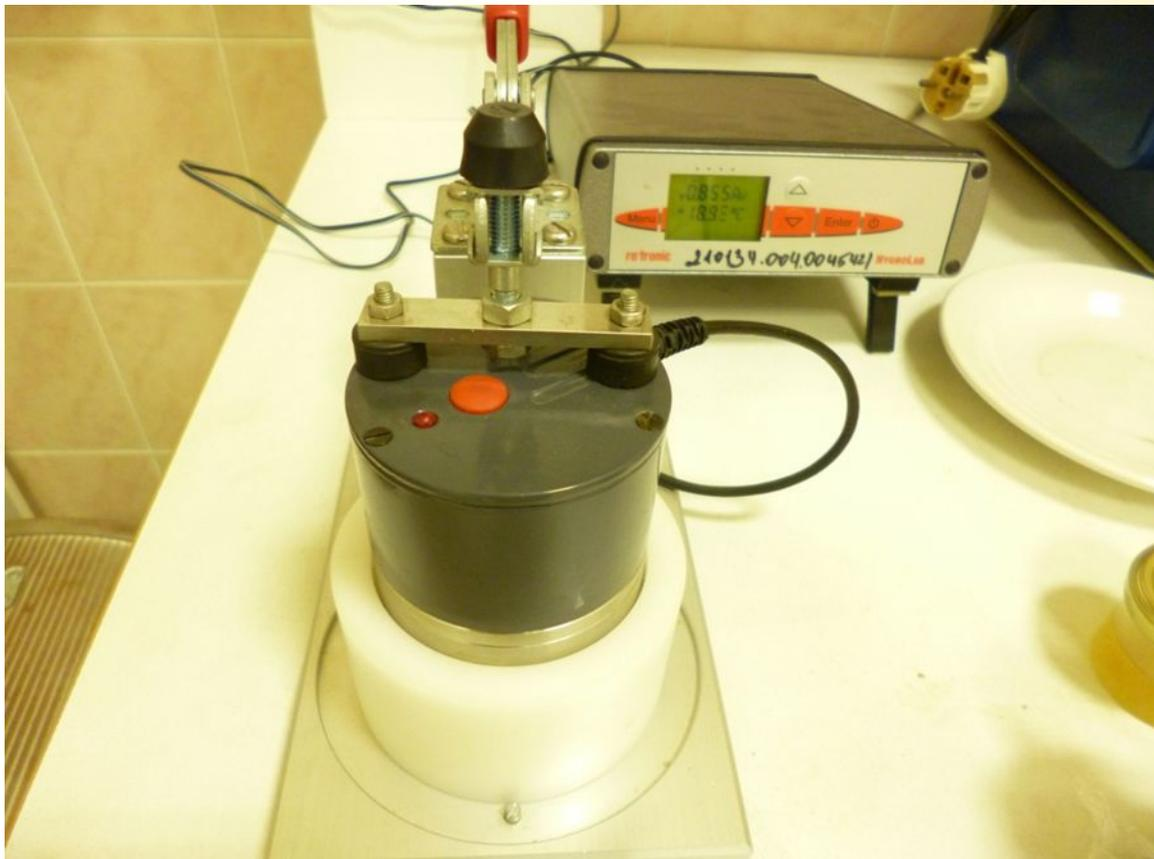
Измерение активности воды в лаборатории
