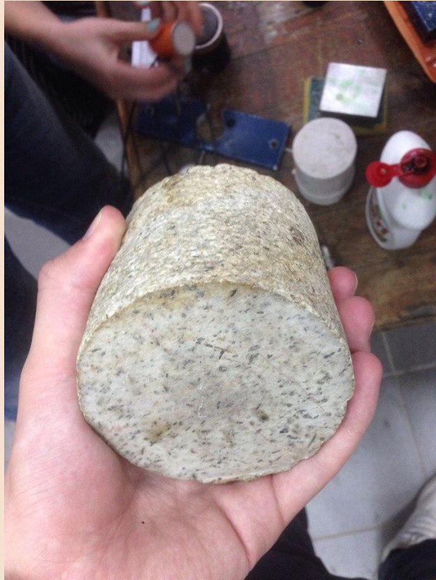
Цилиндрический образец известняка. Плотная осадочная порода.
