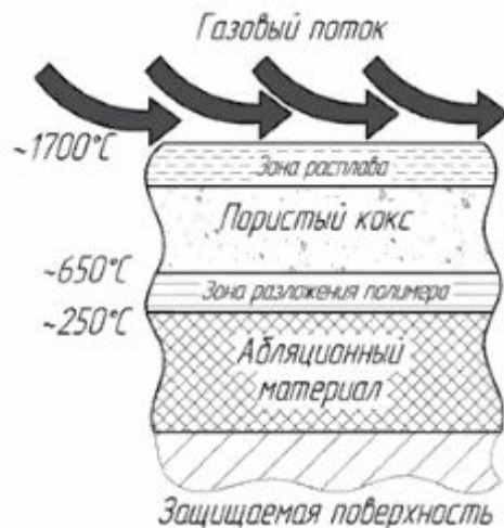
Схема абляции теплозащитного покрытия
