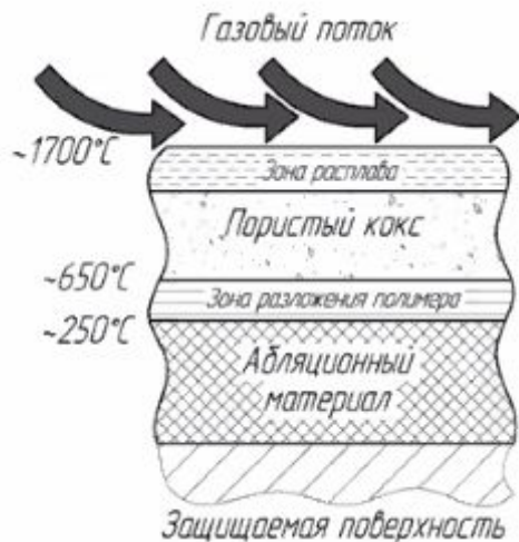
Схема абляции теплозащитного покрытия
