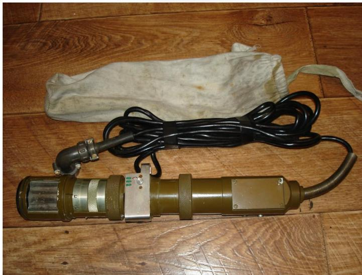
**Полуавтоматический прибор химической разведки (ППХР)** предназначен для решения практически тех же задач, что и ВПРХ. Принцип его работы аналогичен принципу работы ВПРХ. Отличие состоит в том, что воздух через индикаторную трубку просасывается с помощью ротационного насоса, работающего от электродвигателя постоянного тока, а при низких температурах трубки подогреваются с помощью электрогрелки. Питается прибор от электросети автомашин с напряжением 12 в.
