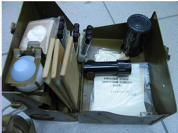
**Войсковой прибор химической разведки (ВПХР)** предназначен для определения в воздухе, на местности, на боевой технике зарина, зомана, иприта, фосгена, дифосгена, синильной кислоты, хлорциана, а также паров V-газов в воздухе.
