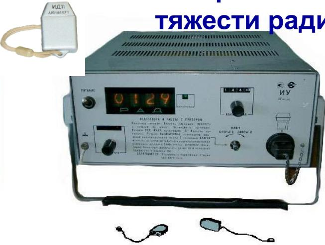
**Измеритель доза ИД-11 представляет собой алюмофосфатное стекло, активированное серебром, размером 10x10мм и толщиной 4мм, которое под воздействием ионизирующих излучений приобретает способность люминесцировать под действием ультрафиолетового света. Интенсивность люминесценции этого стекла служит мерой для определения поглощённой дозы излучения. Снятие показаний с измерителя дозы ИД-11 осуществляется измерительным устройством ИУ-11 с помощью ГО-32**
