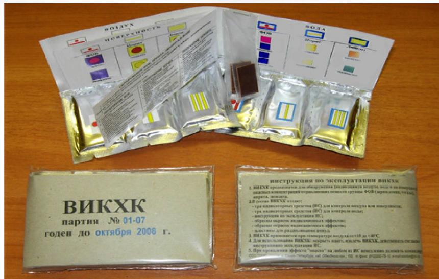
**Войсковой индивидуальный комплект химического контроля (ВИКХК)** обеспечивает обнаружение зараженности воздуха и воды отравляющими веществами (ОВ) типа зарин, зоман, V-газы, иприт, люизит; идентификацию зарина, зомана и V-газов от иприта и люизита; а также обнаружение ОВ типа зоман, V-газы, иприт, люизит на непитывающих поверхностях.
