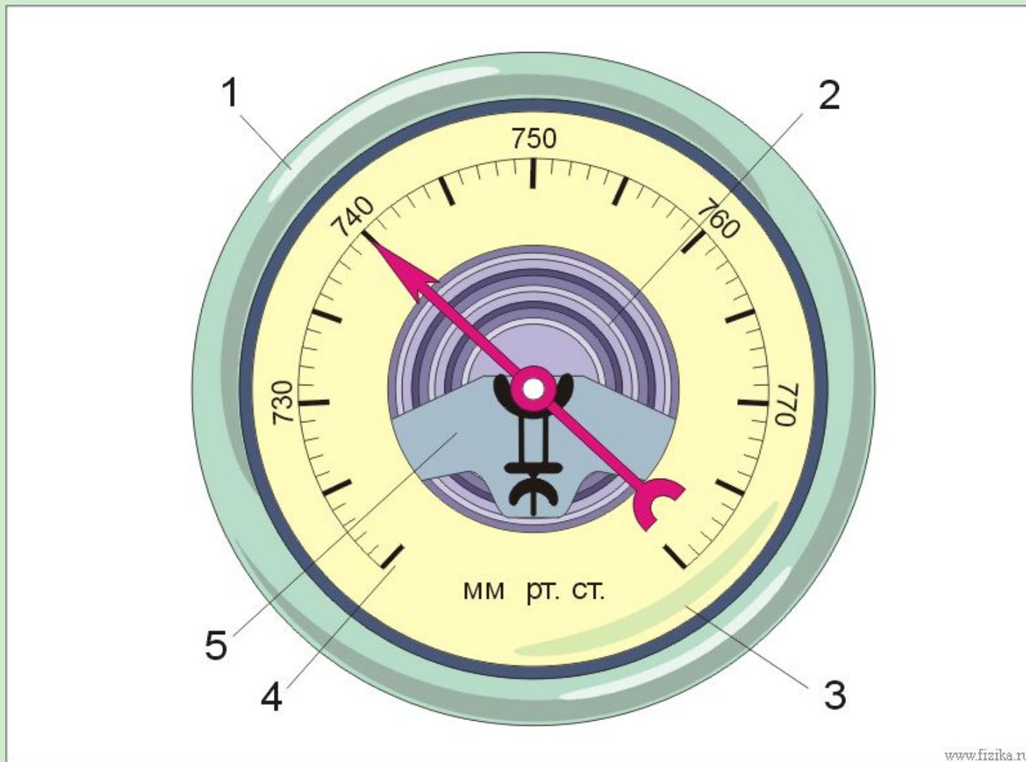
2) Барометр – прибор для измерения атмосферного давления. Определите цену деления шкалы барометра. Что показывает барометр? В каких единицах измеряют атмосферное давление?
