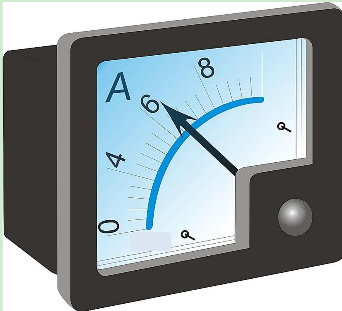
3) Амперметр – прибор для измерения силы тока. Чему равна цена деления амперметра? Чему равна сила тока?
