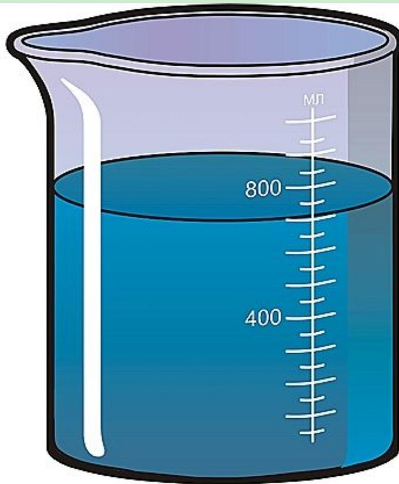
4) Определите цену деления шкалы мензурки и объёмы жидкостей в ней. Запишите показания с учётом погрешности прибора. Каковы пределы измерений мензурки?
