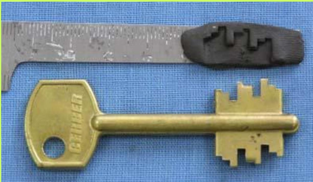
На фотографии вы видите полученный четкий слепок, по которому изготовить ключ не составит труда, имея под рукой нужную заготовку ключа и надфиль. Эту заготовку легко купить в любой ключной мастерской за копейки. Если ключ симметричный, в большинстве всех замков, то слепок достаточно снять один раз с любой половины бородки ключа, если же ключ не симметричный, то придется снимать слепок с двух половин.
