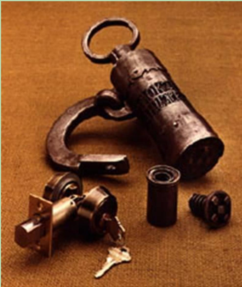
Большое округлое кольцо сверху - это "рукоятка" ключа, на котором есть нарезка и который ввинчивается в замочную скважину, чтобы разблокировать запирающий механизм. Когда скоба становится в позицию запираения, ключ вынимается и вставляется затычка, чтобы казалось, что замочной скважины нет. Нарезная часть ключа ввинчивается затем в защитный футляр.
