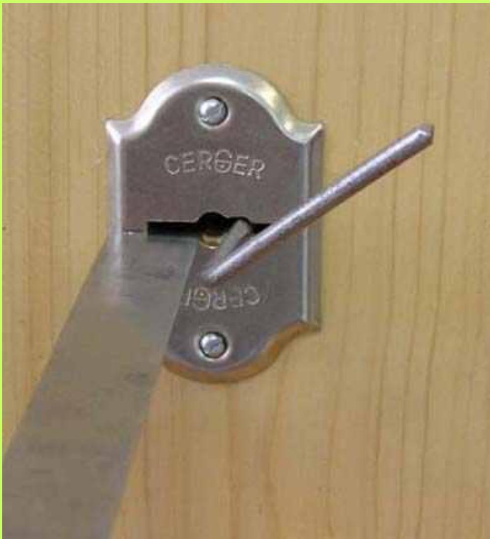
На фотографии зафиксирован процесс снятия слепка с ключа. В данном эксперименте вы видите замок CERBER. Именно на нем специализировались пойманные воры. Манипулируя правой рукой с шилом или другим тонким твердым предметом, левой рукой подсовываете пластину с пластилином.
