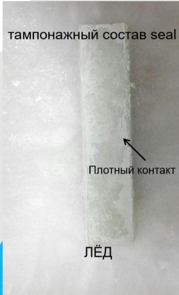
Тампоначный состав FealSel - это уникальный состав на основе высокоактивных вяжущих компаундов, способных гидратировать даже при отрицательной температуре.
