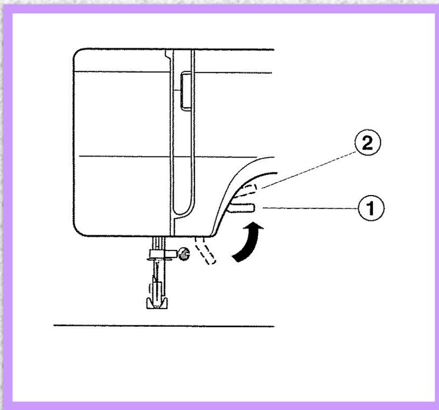
Прижимную лапку можно поднять выше на 0,6см. обычного ее положения для легкой смены лапки и при работе с тяжелыми тканями
