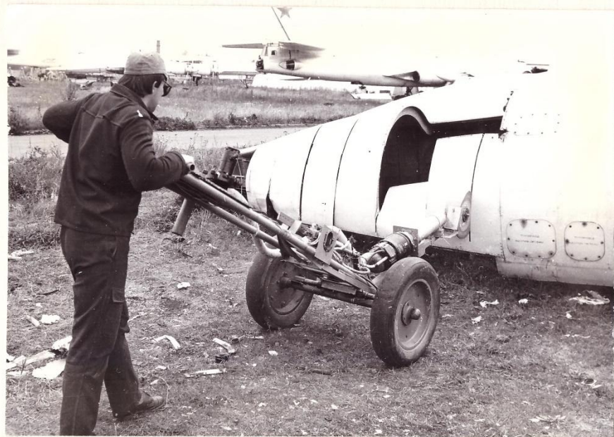
Разделка фюзеляжа в металлолом при помощи установки.
