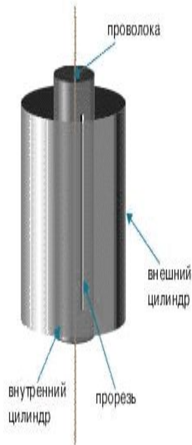
Схема установки Штерна.
