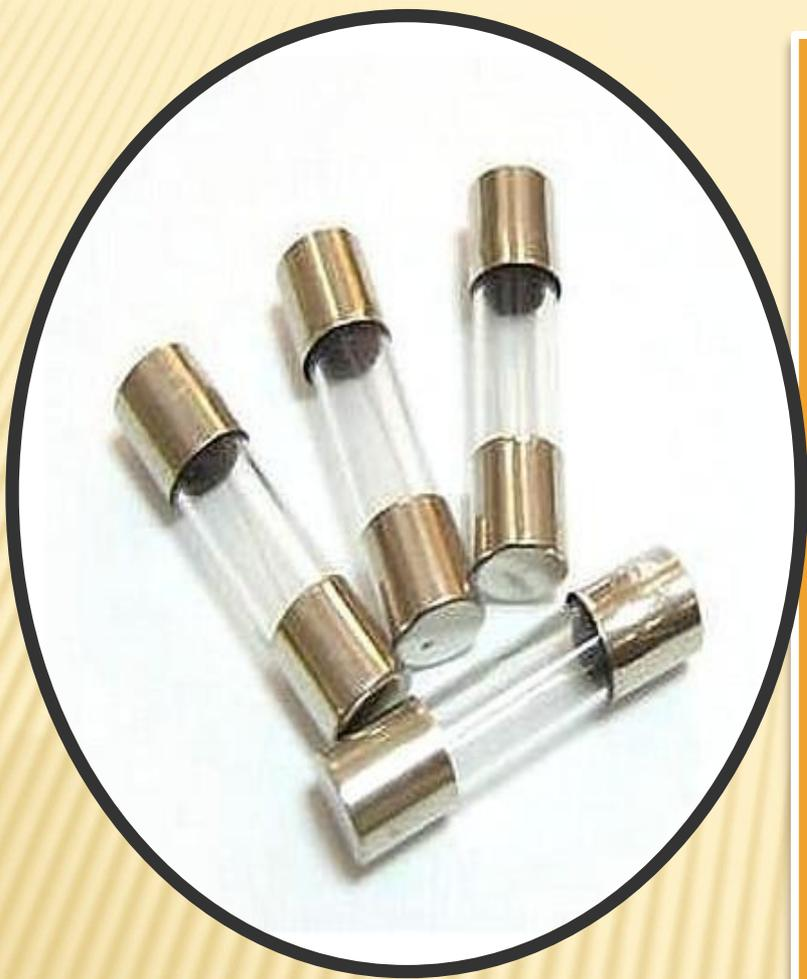
Самый простой вид - плавкая вставка. Она применяется, например, в бытовой радиоаппаратуре.
