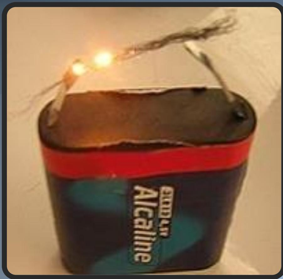
Короткое замыкание - это такое состояние электрической цепи, когда клеммы источника тока замыкаются накоротко без потребителя электроэнергии (без нагрузки).
