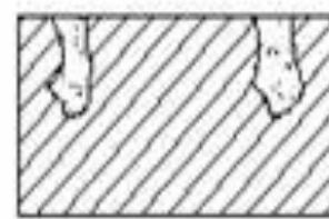
Рис. 8. Местная язвенная коррозия
