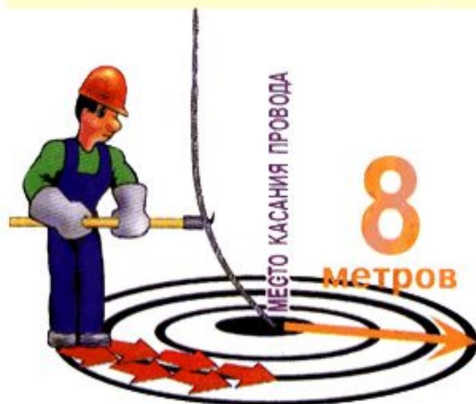
В РАДИУСЕ **8 МЕТРОВ** ОТ МЕСТА КАСАНИЯ ЗЕМЛИ ЭЛЕКТРИЧЕСКИМ ПРОВОДОМ МОЖНО ПОПАСТЬ ПОД **«ШАГОВОЕ» НАПРЯЖЕНИЕ.**
