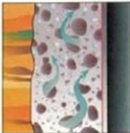
Высокая проницаемость цементного раствора
