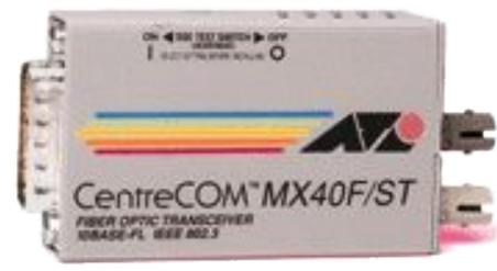
Трансивер устанавливается непосредственно на кабеле и питается от сетевой карты компьютера. С сетевой картой трансивер соединяется интерфейсным кабелем АUI (Attachment Unit Interface).
