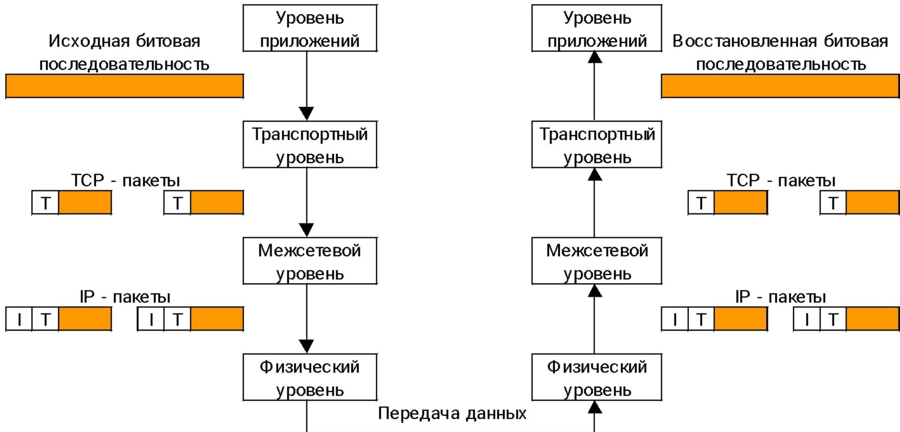
T - Заголовок TCP; I - Заголовок IP.
