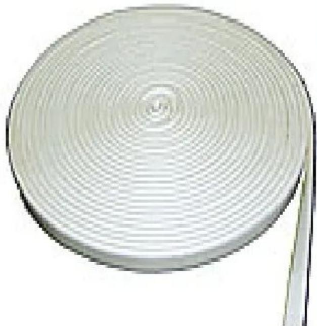
Лента ЛС-ПТФЕ из фторопласта применяется для герметизации неподвижных фланцевых соединений трубопроводов. Температура применения от  $-240^{\circ}\text{C}$  до  $+310^{\circ}\text{C}$ ,  $p=20$  МПа
