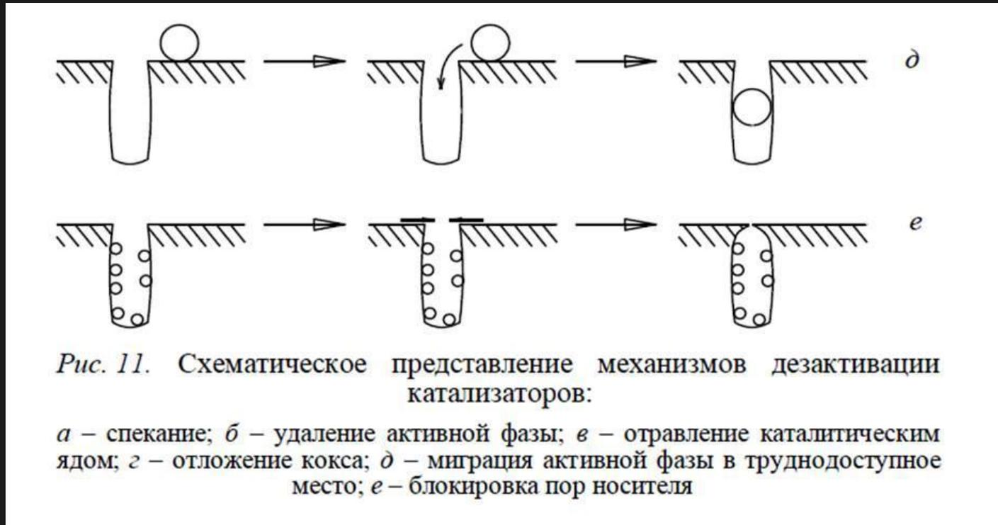
Рис. 11. Схематическое представление механизмов дезактивации катализаторов:
