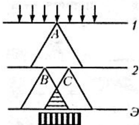
В непрозрачной ширме 1 он проколол булавкой малое отверстие, а в ширме 2 проколол два отверстия. Свет от источника падал на первую ширму. В следствии дифракции свет из отверстия выходит в виде конуса, т.е. дифрагирует.
