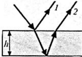
При попадании монохроматического света (самый простой случай) на тонкую пленку часть света отражается от наружной поверхности пленки (луч 1), другая часть света, пройдя через пленку, отражается от внутренней поверхности (луч 2).
