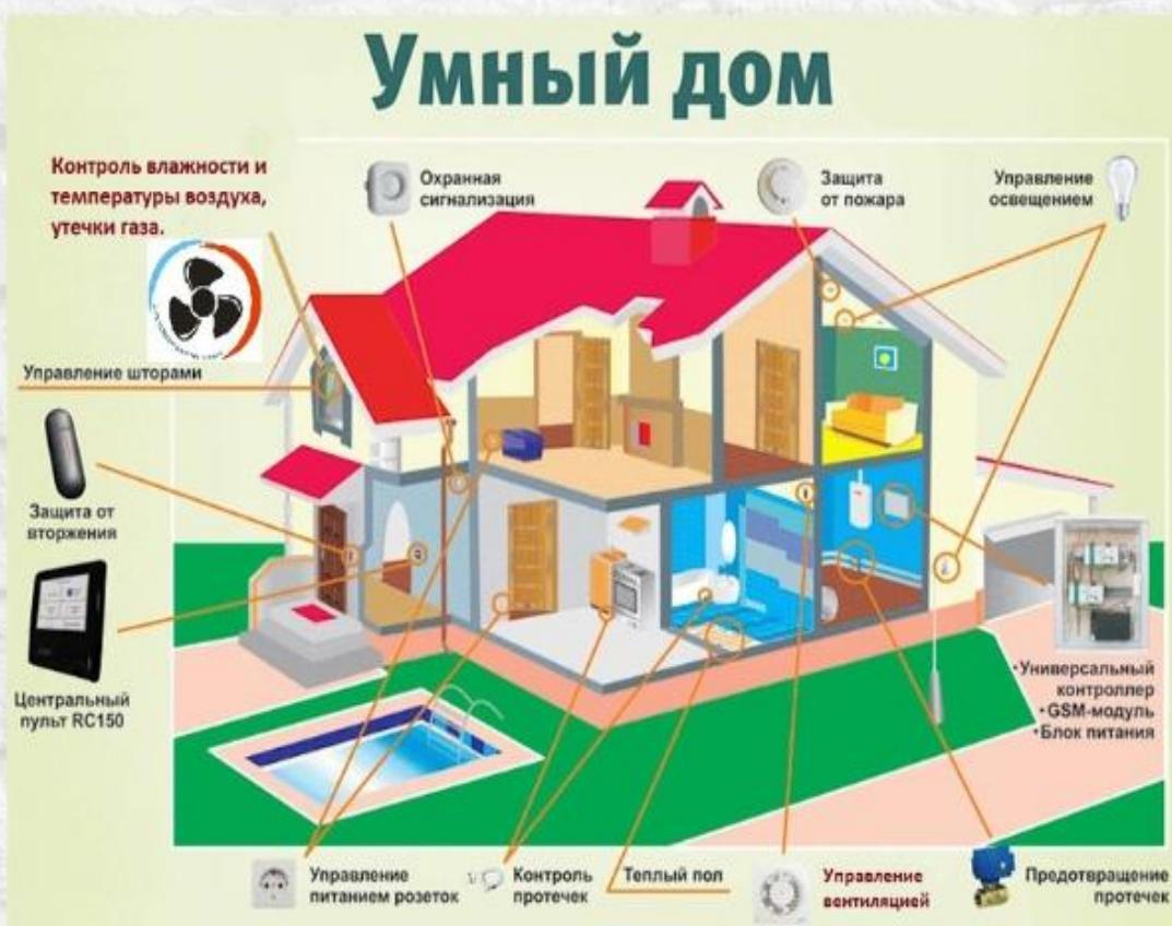
Кроме автономного режима, с контроллером можно связаться через специальный интерфейс (компьютерную сеть, мобильного оператора или радиосеть), и управлять вручную приборами.
