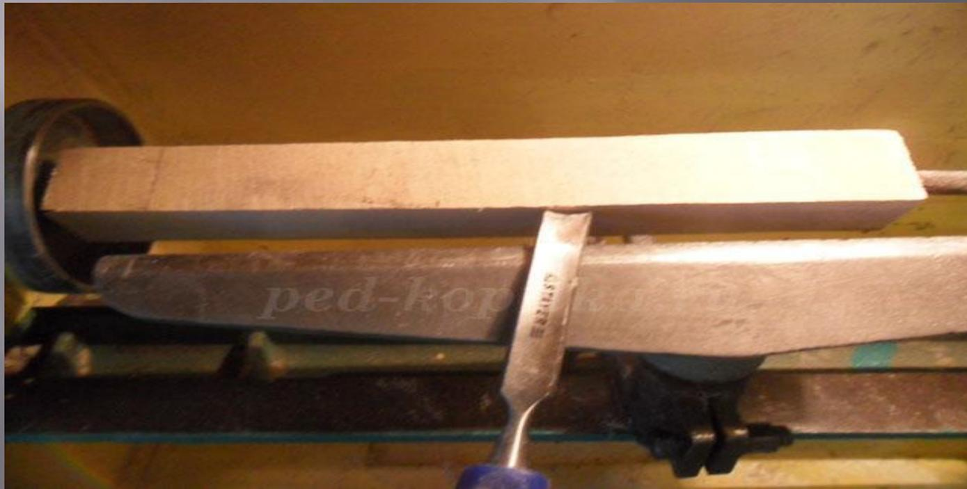
5. От намеченной углублённой риски вытачиваем ручки скалки в виде конуса. (Резак располагаем под углом и движениями туда-сюда вытачиваем ручки).
