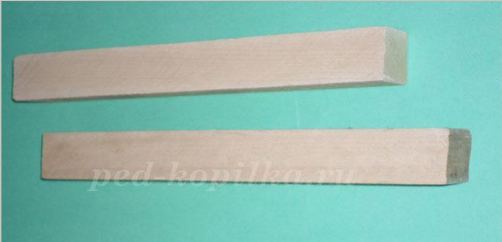
**2. Разметить центры на торцах заготовки. С одной стороны просверлить отверстие под шпиндель задней бабки, с другой сделать пропилы в виде креста под трезубец передней бабки.**
