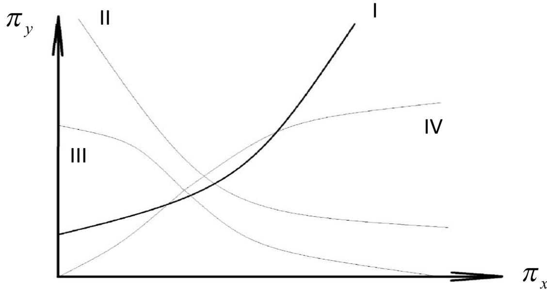
Математически степень влияния одной величины на другую удобно оценивать по виду дифференциальной зависимости между ними. Учитывая, что в одном из предельных случаев зависимости между безразмерными величинами имеют вид  $\pi_x / \pi_y^n = const$ , при  $\pi_x = const$ , для оценки значимости критериев предлагается использовать графики дифференциальной зависимости между логарифмами критериев в виде:
