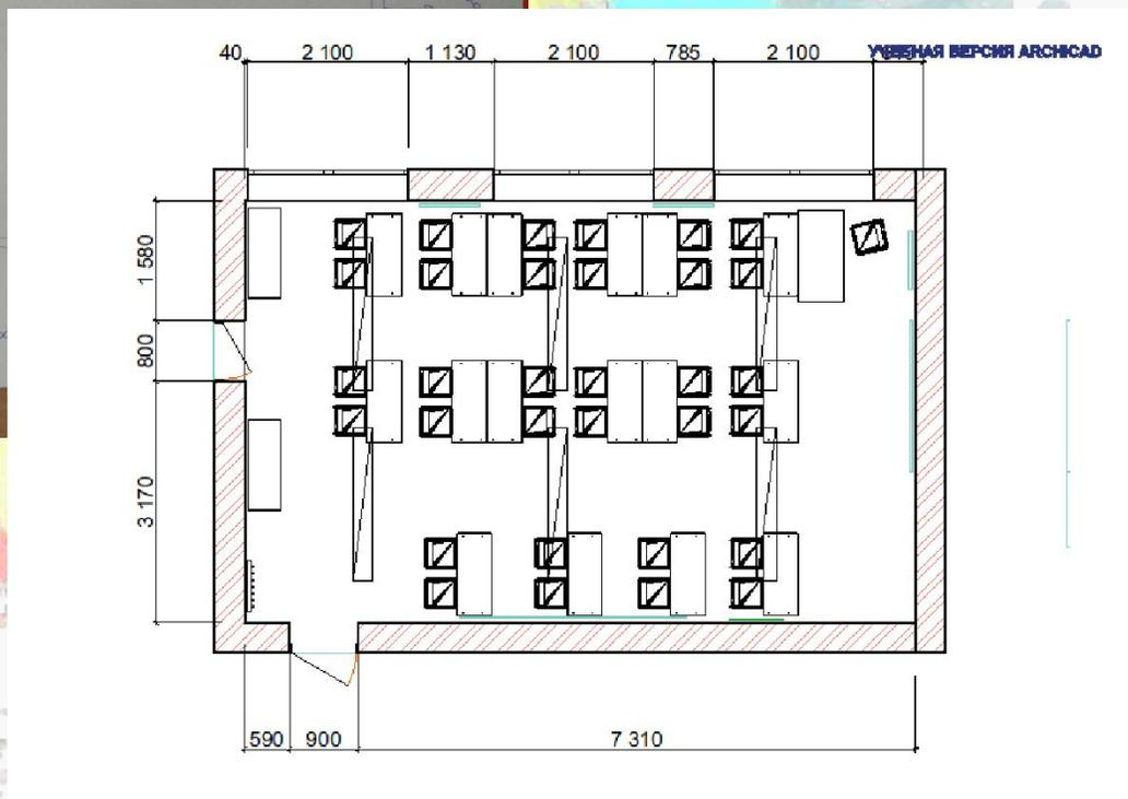
**Обмерочные** чертежи – это схемы планов помещения (ий), развёрток стен квартиры, которые выполняются от руки для того, чтобы быстро образмерить комнату (квартиру) и записать необходимые данные на схему-чертёж. На **обмерочных** чертежах отражают всю необходимую информацию о проектируемом помещении.
