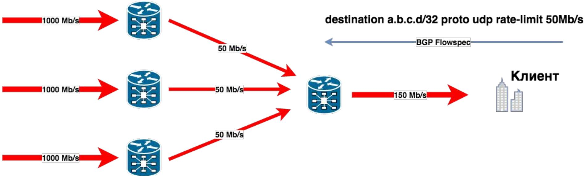
В Cisco ASR9K flowspec применяется на входе -> при наличии N линков(на разных NP) возможны подобные ситуации.
