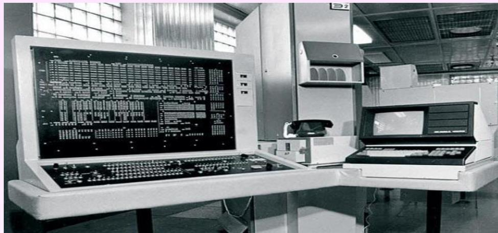
Однако не все отечественные разработки были свернуты. Коллектив В.С.Бурцева продолжал работу над серией ЭВМ "Эльбрус", и в **1980** году ЭВМ "Эльбрус-1" с быстродействием до 15 миллионов операций в секунду был запущен в серийное производство. В **1985** году следующая модель этой серии, "Эльбрус-2", выполнял уже 125 миллионов операций в секунду.
