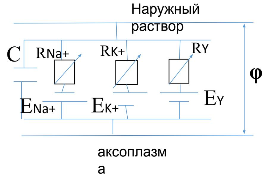
Удельное сопротивление аксоплазмы равно 10-100 Ом•см. Удельное сопротивление волокна диаметром 1 мкм составляет  $10^9$ - $10^{10}$  Ом•см. Удельное сопротивление, в основном, обусловлено липидным бислоем. Но аксон передает импульс на несколько метров без затухания и искажения. Если бы проведение нервного импульса было связано с его передачей вдоль по аксоплазме, то регистрировался бы ток в аксоплазме, а не ионные потоки внутрь и вовне аксона.
