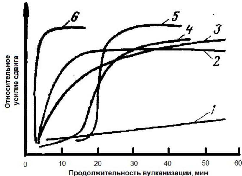
Зависимость кинетики вулканизации серой ненаполненных смесей на основе НК при 144°C (по усилию сдвига) от типа ускорителя: 1 – без ускорителя; 2 – меркаптобензтиазол; 3 – дифенилгуанидин; 4 – дибензтиазолилдисульфид; 5 – N-циклогексил-2-бензтиазолилсульфенамид; 6 – диметилдитиокарбамат цинка.
