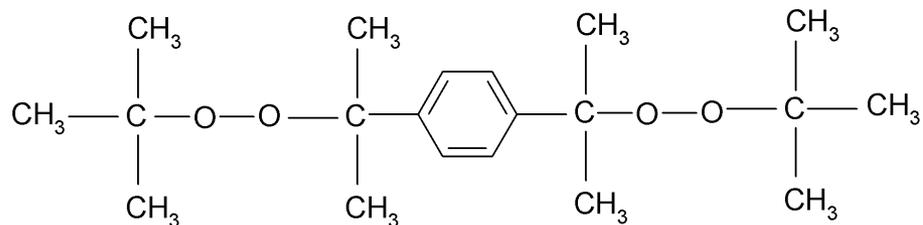
Вулканизаты, полученные с применением пероксидов, имеют высокую стойкость к тепловому старению, вследствие образования в процессе вулканизации термостойких С – С связей.
