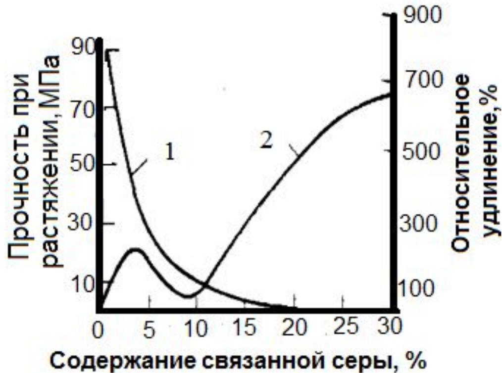
Влияние содержания связанной серы на прочность при растяжении и относительное удлинение вулканизатов НК: 1 – относительное удлинение, 2 – прочность при растяжении
