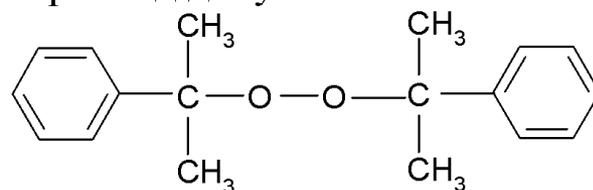
Пероксид дикумила дает возможность перерабатывать резиновые смеси при температуре до 100°C. Температура вулканизации в его присутствии 135 – 260°C. Вулканизаты имеют неприятный запах. Он применяется для вулканизации силиконовых, уретановых, этиленпропиленовых, фторкаучуков, а также непредельных полимеров.
