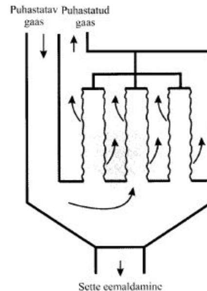
*Joonis 28. Filterpüüdja*
