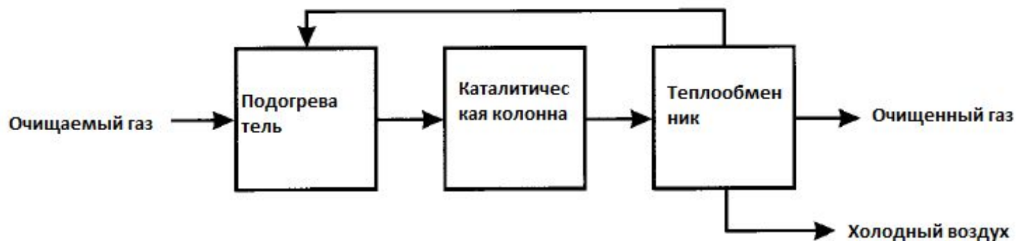
Каталитическая схема аппарата газоочистки
