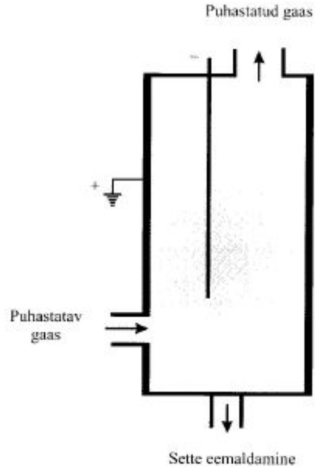
*Joonis 30. Elektrofiler*
