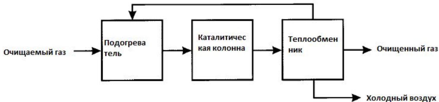
Каталитическая схема аппарата газоочистки
