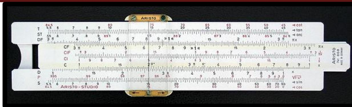
Логарифмическая линейка — вычислительное устройство, позволяющее выполнять несколько математических операций: умножение и деление чисел, возведение в степень (чаще всего в квадрат и куб), вычисление квадратных и кубических корней, логарифмов, тригонометрических функций и другие операции.
