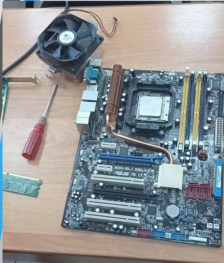
Материнская плата - печатная плата, являющаяся основой построения модульного устройства, например — компьютера. Системная плата содержит основную часть устройства, дополнительные же или взаимозаменяемые платы называются платами расширений
