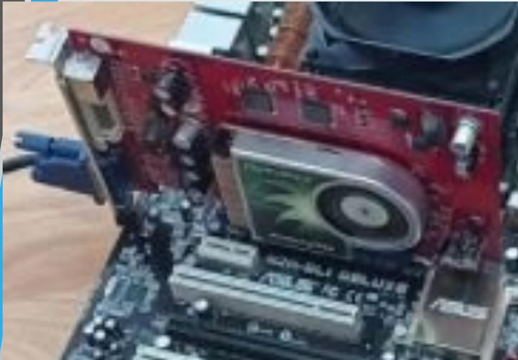
Видеокарта (также видеоадаптер, графический адаптер, графическая плата, графическая карта, графический ускоритель) – устройство, преобразующее графический образ, хранящийся как содержимое памяти компьютера, в форму, пригодную для дальнейшего вывода на экран монитора. Первые мониторы, построенные на электронно-лучевых трубках, работали по телевизионному принципу сканирования экрана электронным лучом, и для отображения требовался видеосигнал, генерируемый видеокартой.
