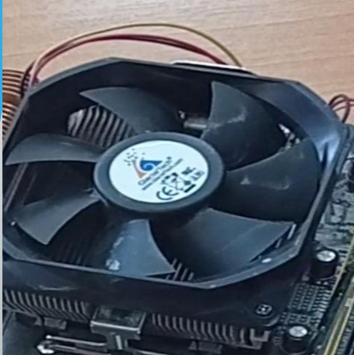
Кулер - совокупность вентилятора с радиатором, устанавливаемых на электронные компоненты компьютера с повышенным тепловыделением (обычно более 5 Вт): центральный процессор, графический процессор, микросхемы чипсета.
