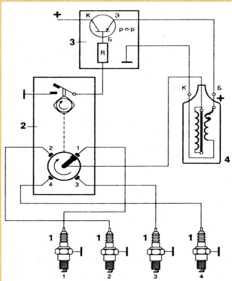
1. Свечи зажигания
