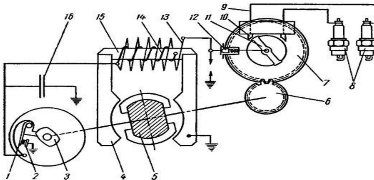
1. Подвижный контакт прерывателя зажигания.
