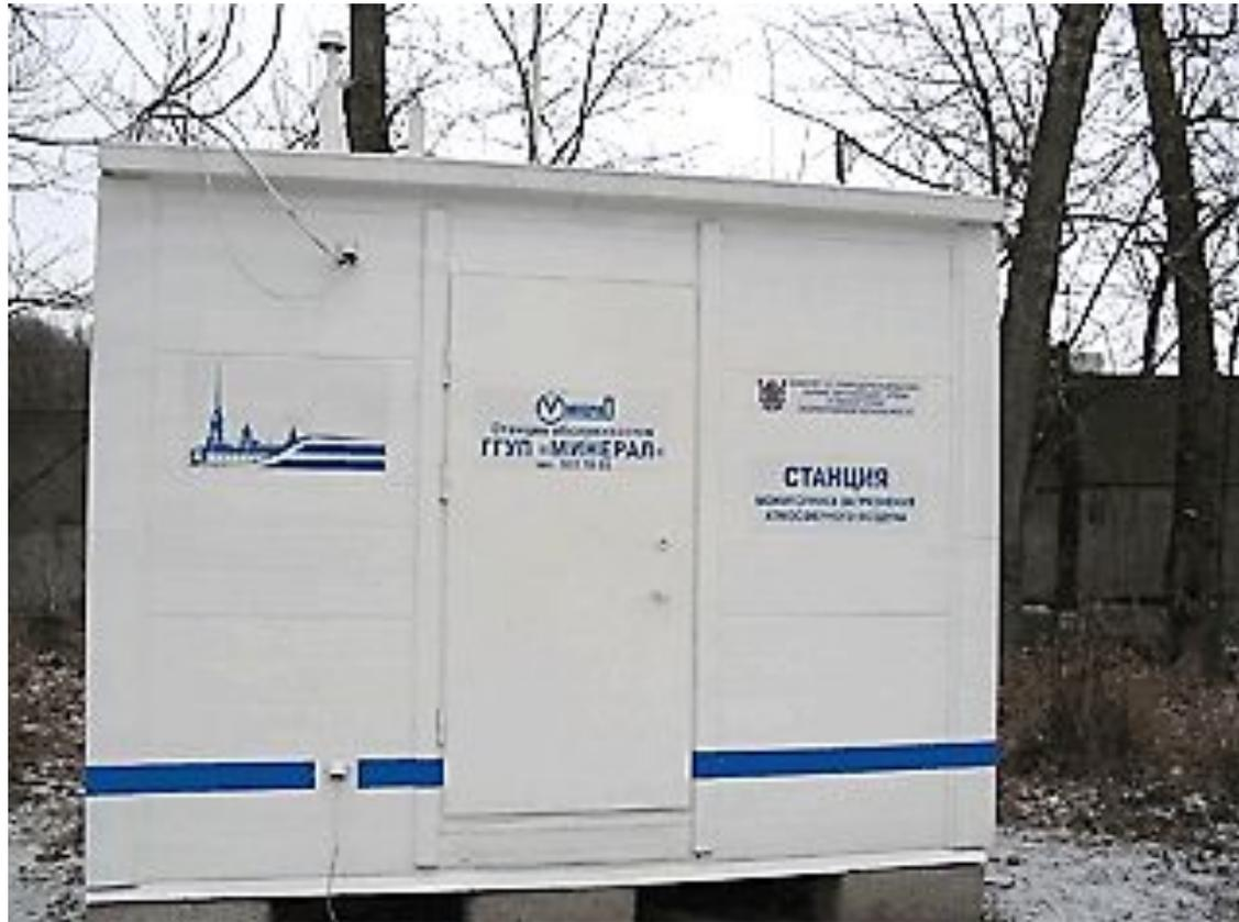
Предназначена для автоматизированного сбора, обработки и передачи информации об уровне загрязнения атмосферного воздуха.
