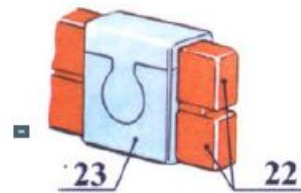
Соединение стержней хомутиком
