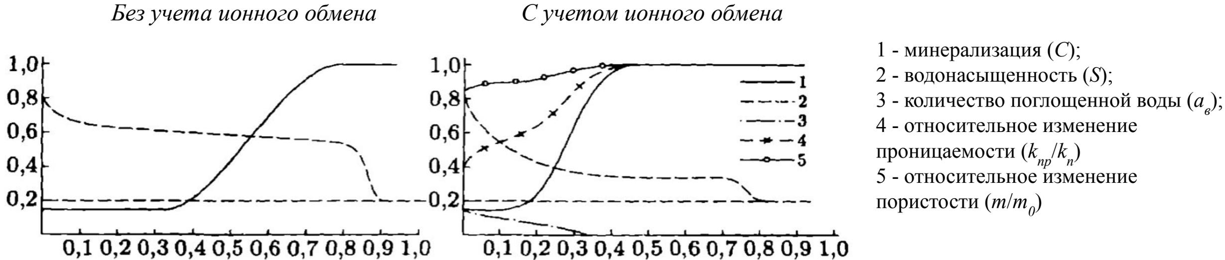
Рис. 1. Характер изменения геофизических характеристик пласта по расстоянию от скважины в области, занятой фильтратом промывочной жидкости
