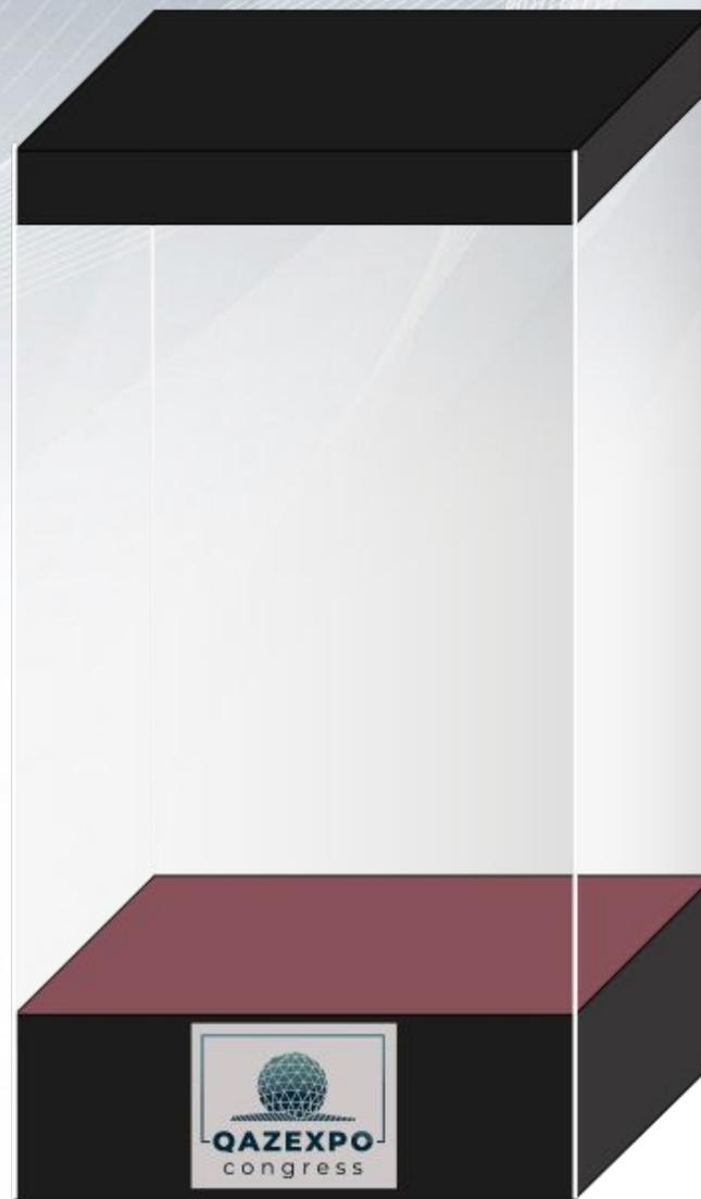
**2.2 Изготовление Витрин размером: ширина - 2000 мм; высота - 2200 мм, глубина - 600 мм для вертикального и горизонтального экспонирования в количестве 10 (десяти) штук. Витрины должны быть изготовлены:**
