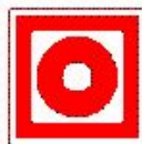
Кнопка включе- ния пожарной автоматики
