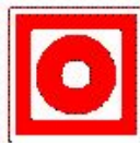
Кнопка включе- ния пожарной автоматики
