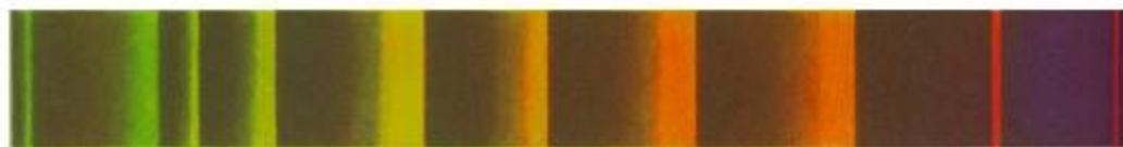
Спектр угольной дуги (полосы молекул CN и C<sub>2</sub>)
