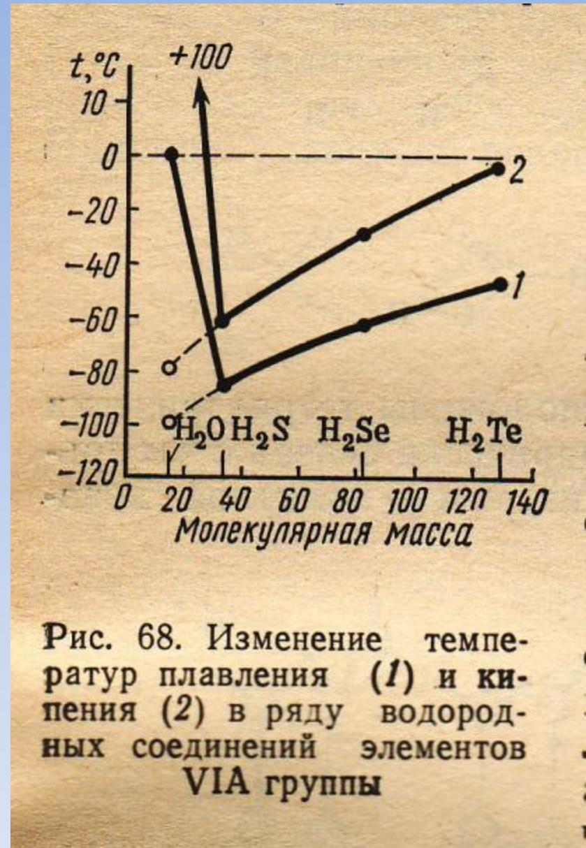
Рис. 68. Изменение температур плавления (1) и кипения (2) в ряду водородных соединений элементов VIA группы
