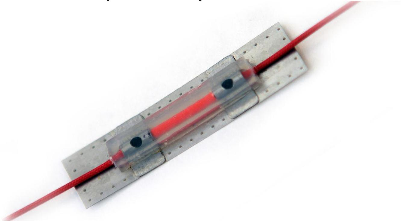
Рис. 1 – Волоконно-оптический датчик
