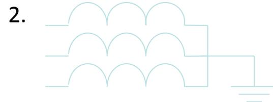
3) Нейтраль, заземленная через дугогасящий реактор
