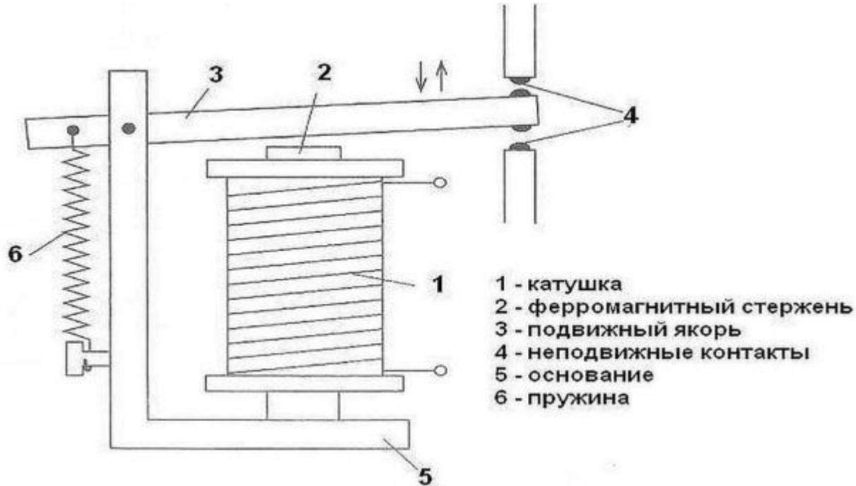
При подаче напряжения на обмотку в ней возникает электромагнитное поле. Закрепленный подвижно якорь притягивается к сердечнику катушки, контакты переключаются (смыкаются/размыкаются). В этом и состоит работа реле — перекидывать контакты.
