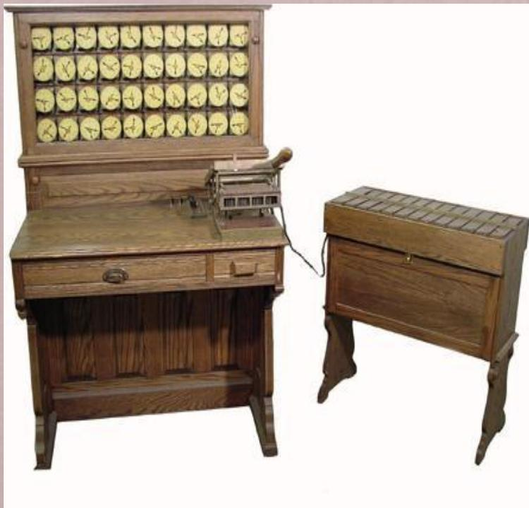
Первый счетно-аналитический комплекс был создан в США в 1887 г. Г. Холлеритом (табулятор Холлерита). Он использовался для переписи населения в России (1897 г.), США (1890 г.) и Канаде (1897 г.), для обработки отчетности на железных дорогах США, в крупных торговых фирмах.
