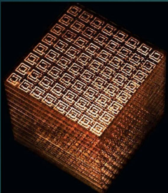
Куб метаматериала представляет собой трехмерную матрицу, образованную медными проводниками и кольцами с разрезом. Микроволны с частотами около 10 ГГц ведут себя в таком кубе необычно, потому что для них куб имеет отрицательный показатель преломления. Шаг решетки — 2,68 мм, или около 0,1 дюйма
