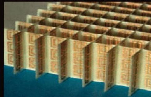
Метаматериал построен из матрицы проводников и колец с разрезом, размеры которых меньше, чем длина электромагнитных волн, для которых предполагается использовать материал
