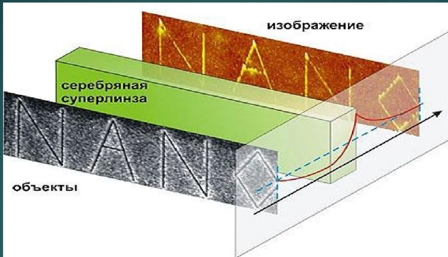
Нанометровое изображение, построенное с помощью суперлинзы: разрешение превышает дифракционный предел.
