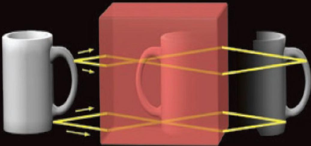
Веселаго использовал построение хода лучей, чтобы предсказать, что брусок из материала с отрицательным показателем преломления  $n = -1$  должен действовать как линза с уникальными свойствами. Большинство из нас знакомо с линзами из материалов с положительным преломлением — в камерах, лупах, микроскопах и телескопах. Они имеют фокусное расстояние, и место, где формируется изображение, зависит от сочетания фокусного расстояния и расстояния между объектом и линзой.
