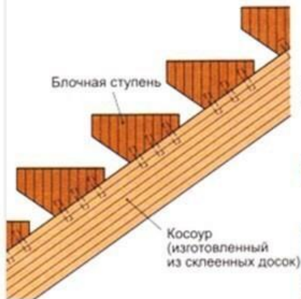
Закрепленная с помощью дюбелей блочная ступень
