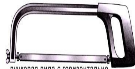
лучковая пила с горизонтально установленным полотном
