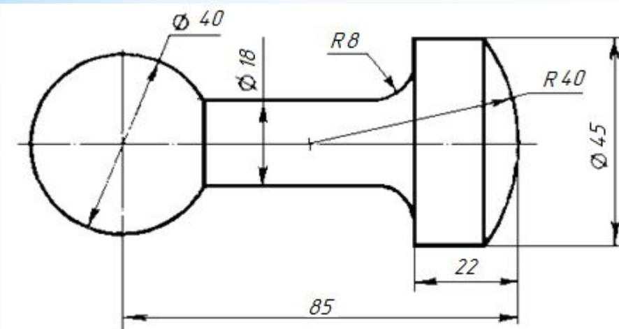
Перед размерным числом диаметра во всех случаях следует наносить знак диаметра  $\Phi$ , а перед размерным числом радиуса — букву  $R$ . Размер радиуса или диаметра сферической поверхности может сопровождаться словом «сфера» в случае, когда это не ясно из чертежа.
