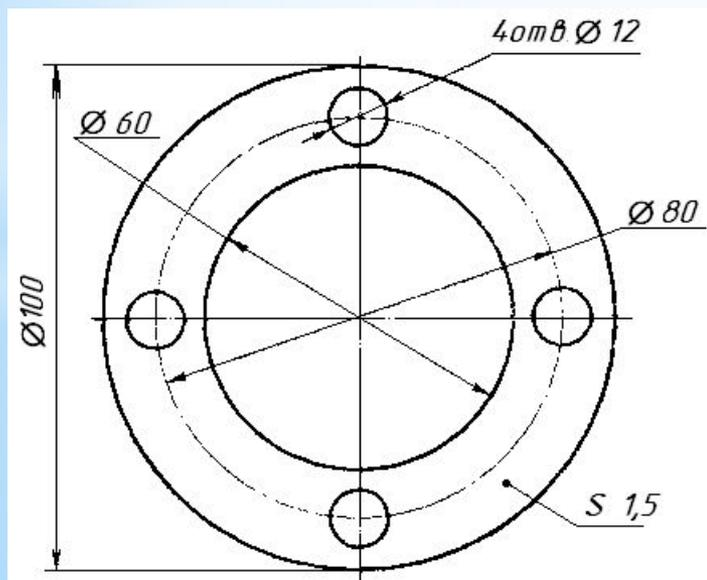
При изображении детали в одной проекции размер **ТОЛЩИНЫ** наносят на полкевыноске  $S 1,5$ .
