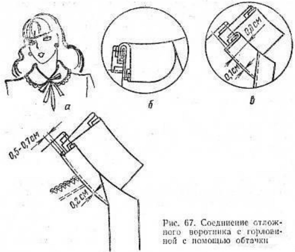
Рис. 67. Соединение отложного воротника с горловиной с помощью обтачки
