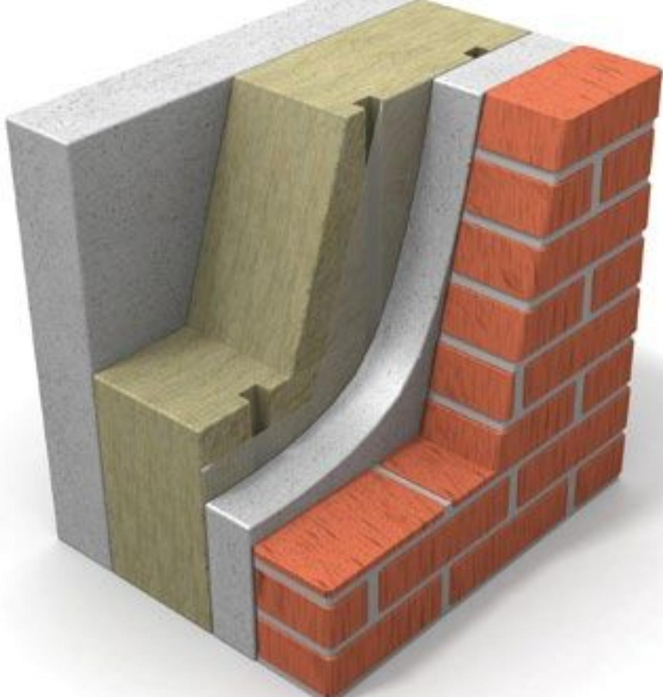
Плиты PAROC можно применять для утепления монолитных трехслойных стен:
