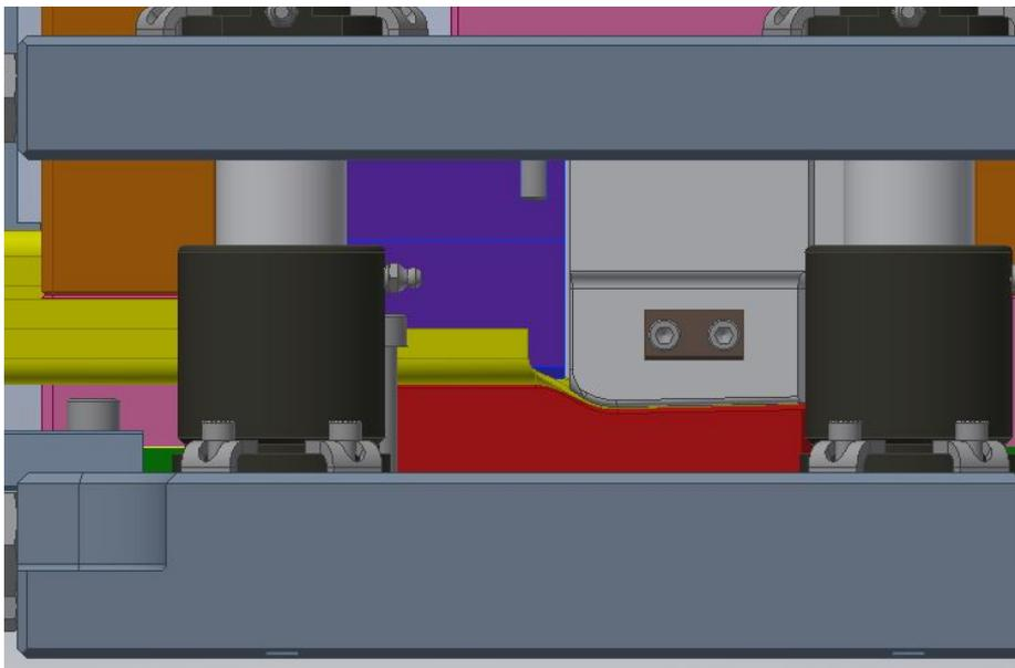
Изменить размеры прижимов и формовочных пуансонов на основе примера изложенного в ММ «штамп закрыт 02»
