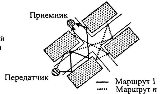
Вследствие многолучевости результирующий сигнал в точке приема представляет собой интерференцию собственных смещенных по времени копий с разными амплитудами. Поскольку прямой и отраженные сигналы проходят различные расстояния, эти сигнальные копии отличаются также и фазами. Кроме того, амплитуды сигналов в точке приема могут как суммироваться, так и взаимно поглощаться (вычитаться). Такие явления называют *замираниями*. Динамический диапазон замираний может достигать 40 дБ [5].
