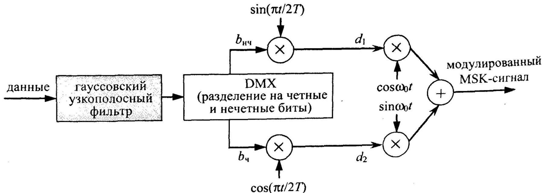
Дальнейшее сужение спектра сигнала достигается за счет дополнительной фильтрации модулирующих посылок «гауссовским» низкочастотным фильтром. Соответствующая разновидность модуляции имеет название *гауссовской MSK* (Gaussian Minimum Shift Keying, GMSK).
