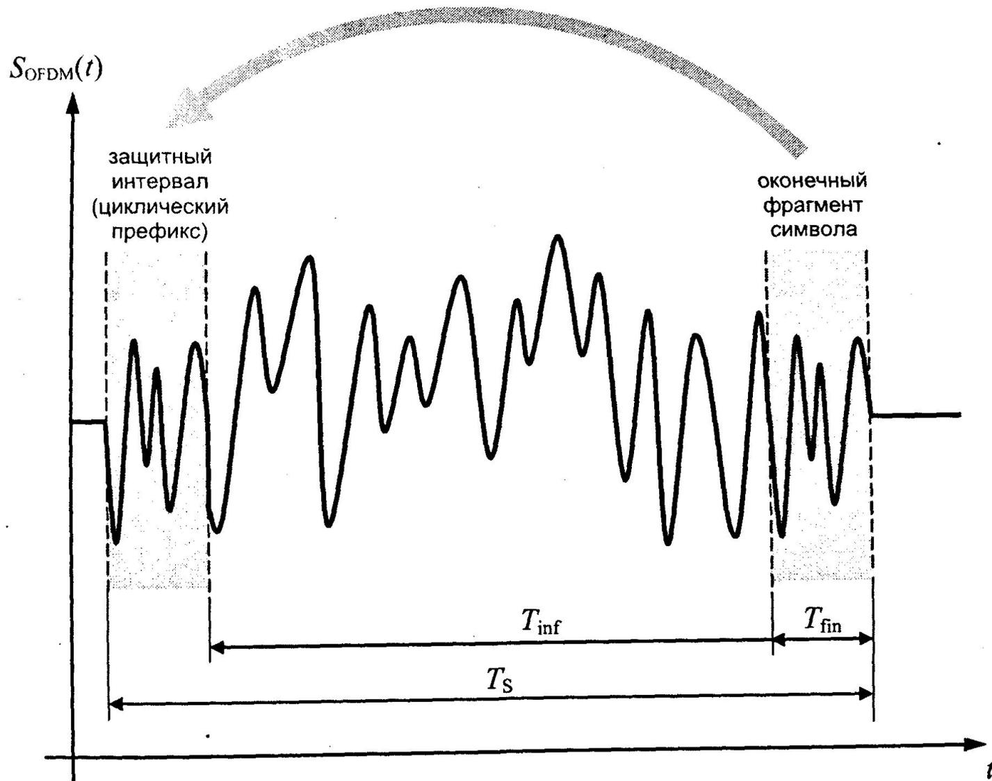
Таким образом, определенный на интервале  $\Delta$  циклический префикс есть усеченное периодическое продолжение сигнала:
