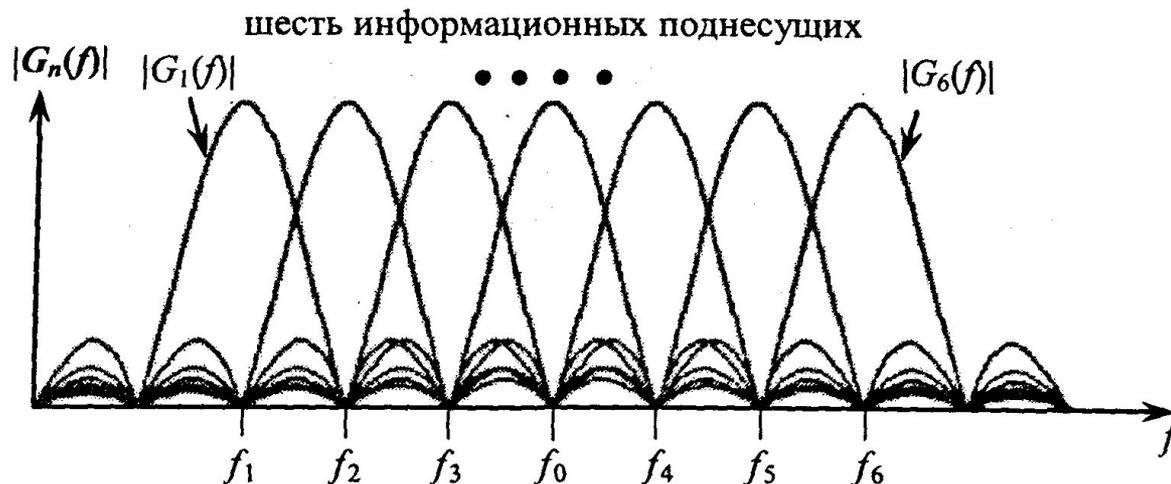
Реализация функций OFDM-модулятора на базе цифрового процессора БПФ предполагает переход от непрерывного времени к дискретному ( $t=nT$ ). При этом выражение (2.10) с учетом периода дискретизации  $T=T_s/N$  примет вид
