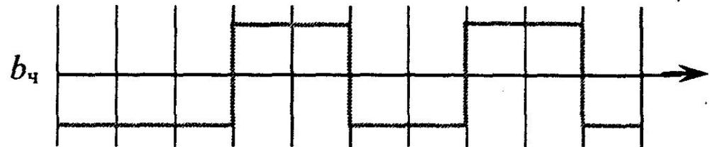
Модулирующий сигнал,  $b_{нч} \times \sin(\pi t/2T)$
